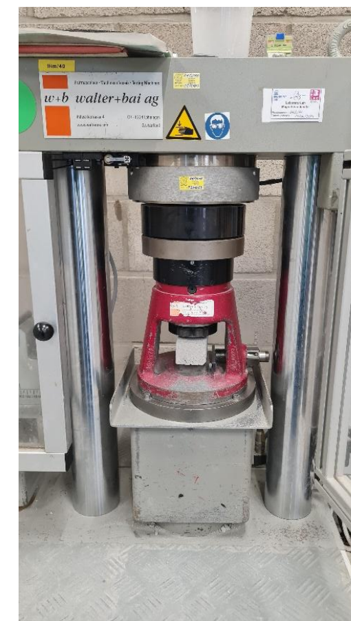
Compression test EN 12390-3
